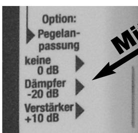
Schalter "Pegelanpassung" am HF-Analyser auf "Dämpfer -20 dB" schalten (siehe Bild). Damit tritt die integrierte Umrechnung der Anzeigeeinheit in Kraft.
